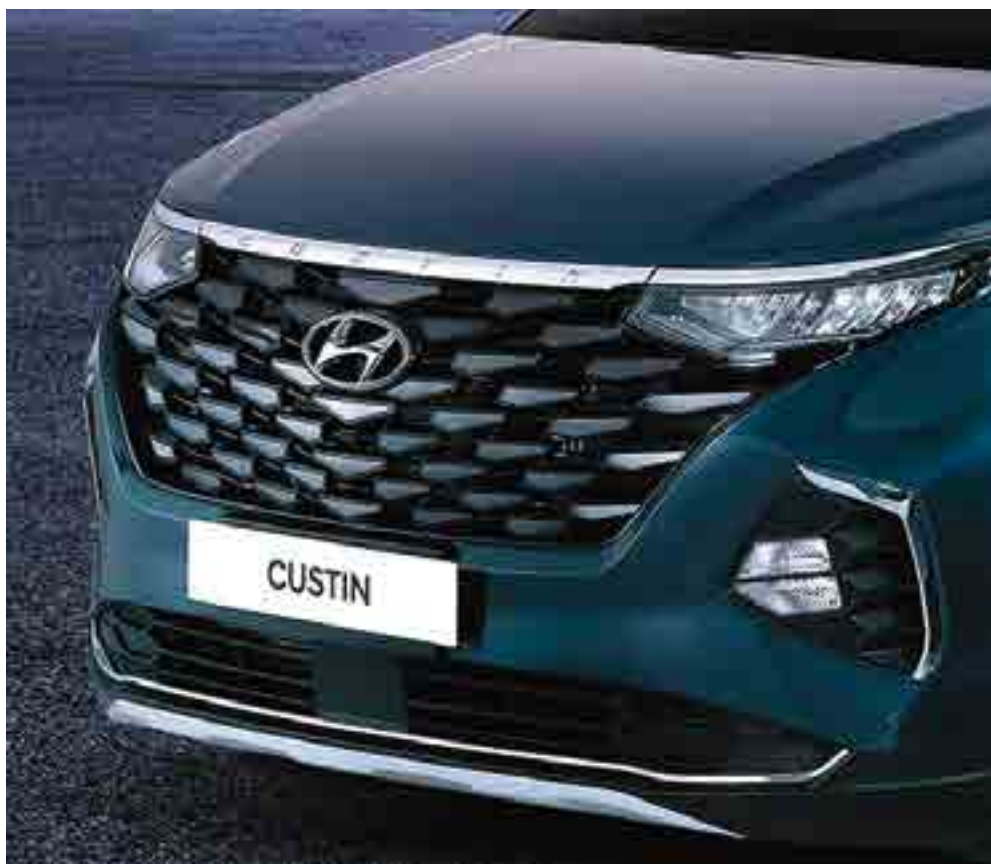
Күндізгі жүріс шамдары (КЖШ) бар ромб түріндегі параметрлік радиатор торы
